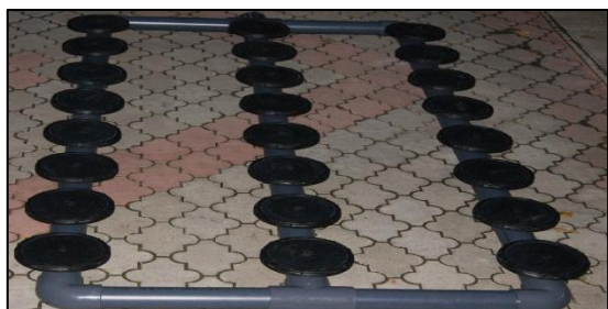
Fot. 1 – balastowany segment napowietrzający z dyfuzorami ES/GJ-HD-270
